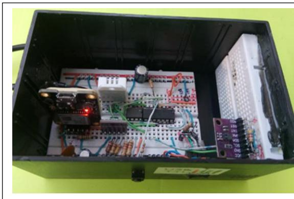
Figure 3 : Le modèle du système APOMOS pour mesurer les concentrations du NO<sub>2</sub>
